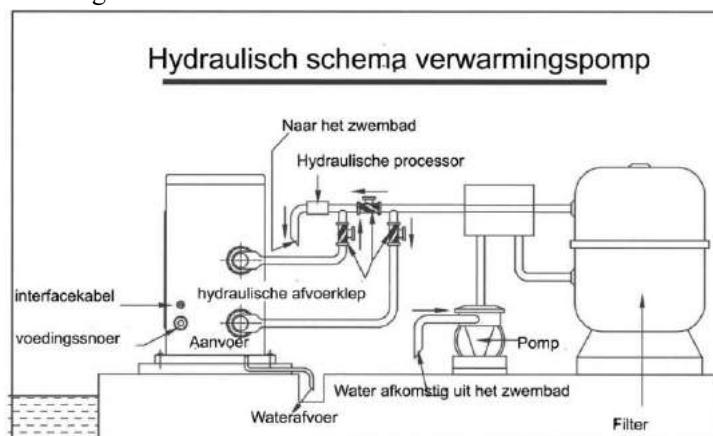
Schema hydraulische aansluitingen (Opmerking: dit schema wordt ter referentie weergegeven. Het weergegeven hydraulische circuit is slechts een basis.)
