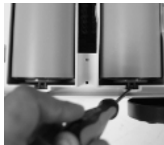
8.2: Als het vuil niet gemakkelijk te bereiken is, gebruik een platte schroevendraaier om de rollen tijdelijk te verwijderen. Duw tabblad, zoals aangegeven in afbeelding om het te verwijderen.
